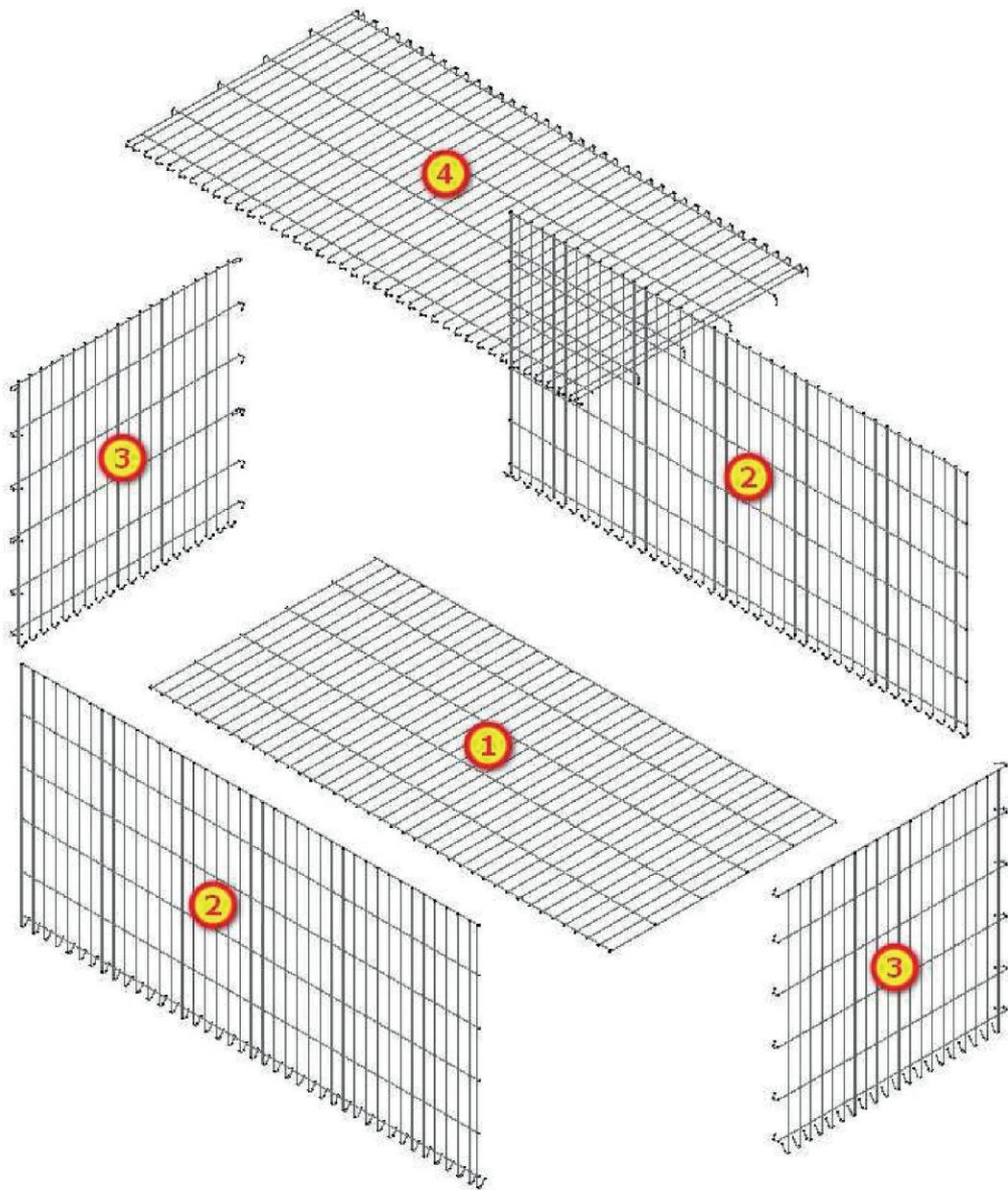
**Figura A.1 – I pannelli in rete che compongono il gabbione**
