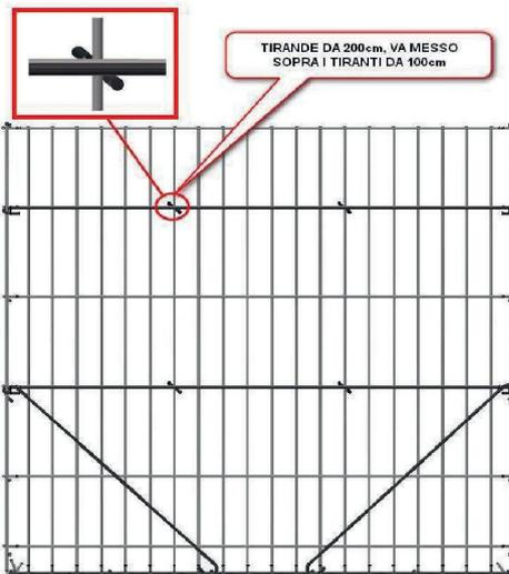
**Figura A.13 – Fase 11: inserire i restanti tiranti, posizionando i tiranti di L cm 200 sopra quelli di L cm 100**
