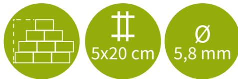
GABBIONI PROFESSIONALI in rete elettrosaldata con filo di diametro 5,8 mm zincato a caldo in classe A (Zn/Al 95/5).
